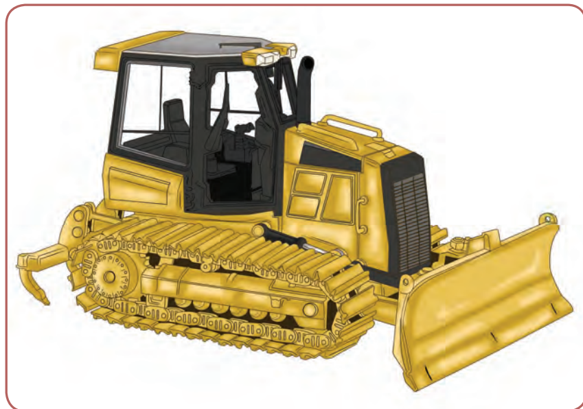
Figura 5 – Trator com lâmina bulldozer
