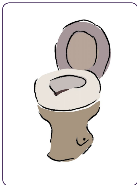
Figura 11 – Correção para aumentar a altura do vaso
